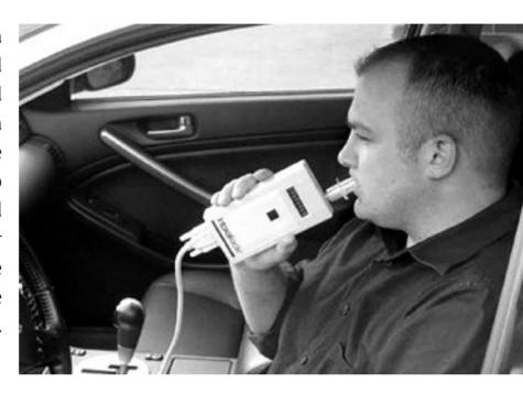
l alcohol interlock o alcolock es un dispositivo para medir el grado de alcoholemia en el aire espirado que, conectado generalmente al contacto del vehículo, impide el arranque y, en definitiva, la conducción del vehículo bajo los efectos del alcohol.
