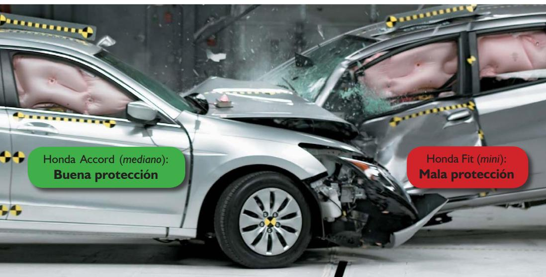
En esta foto de un choque de prueba se puede observar cuán distintos reaccionan al impacto dos autos que tienen mucho en común excepto el tamaño.
