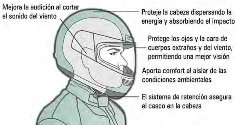
El casco ejerce su efecto protector por medio de su estructura formada por cuatro componentes básicos:
